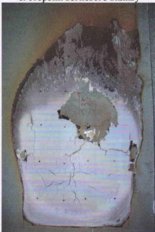
Пошкодження матеріалів, з яких виготовлено зразок після випробувань
